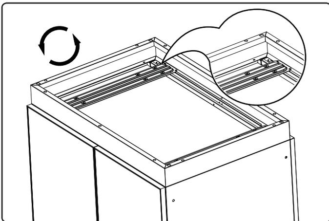
**3** Alignez le pied sur les trous de la traverse. Installez les boulons à tête hexagonale.
