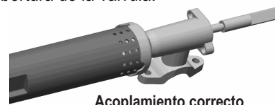
Acoplamiento correcto del quemador con la válvula
