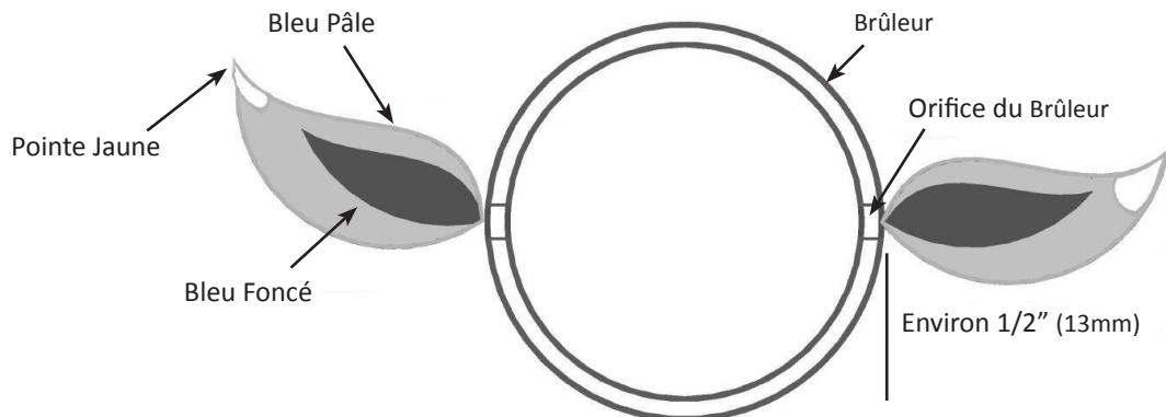
**Ajustement De L'air De Combustion (ceci doit être effectué par un installateur qualifié):** Le volet d'air est réglé à l'usine et ne devrait pas avoir besoin normalement d'être ajusté. Cependant dans des conditions exceptionnelles un ajustement peut être requis. Lorsque le volet d'air est bien ajusté, les flammes seront bleues foncées avec des pointes bleues pâles ou quelques fois jaunes.
