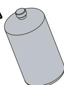
**AVERTISSEMENT!** Le bouchon devrait être mis en place lorsque le cylindre n'est pas utilisé afin d'empêcher la saleté et les débris de pénétrer à l'intérieur.
